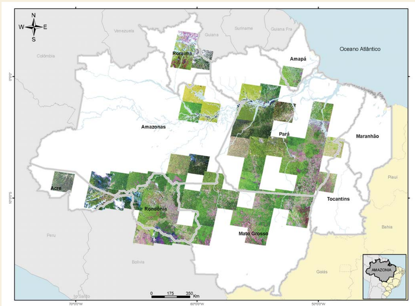
Figura 10. Cenas Landsat utilizadas na validação dos polígonos de desmatamento detectado pelo SAD em setembro de 2009.
